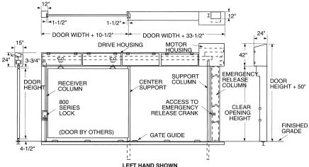
BI-PARTING GATE OPERATOR MOTOR HOUSING AND EMERGENCY RELEASE CAN BE LOCATED AT EITHER END
